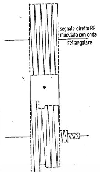
Fig. 14. - Segnale risultante alla fine della linea di trasmissione quando le successive riflessioni sono sfasate di  $180^\circ$ .
