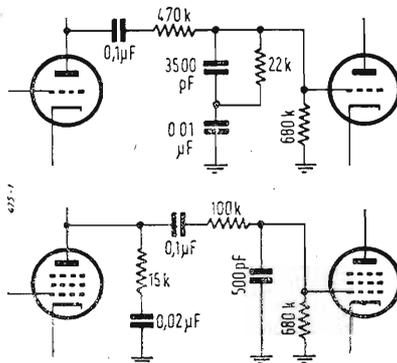
Fig. 1. - Circuiti equalizzatori RCA per la curva RIAA.
