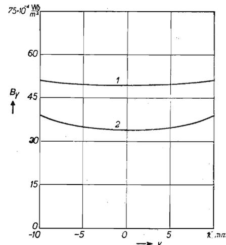
Fig. 5. - Variazione lungo l'asse  $y$  del campo magnetico di un magnete del tipo di fig. 1 (curva 1) e del tipo di fig. 6 (curva 2).
