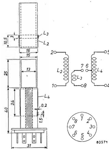
Fig. 7 - Dati costruttivi del trasformatore a rapporto.
