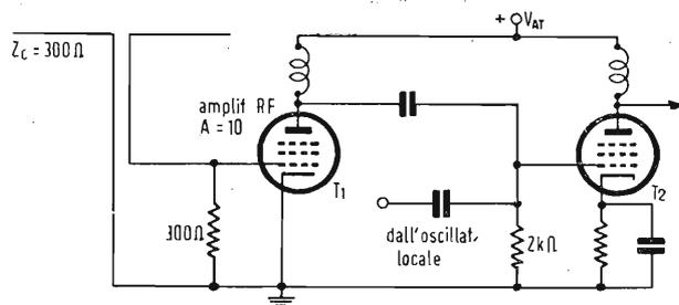
Fig. 19. - Amplificatore BF e convertitore tipici per un ricevitore TV.
