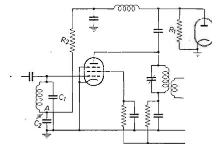
Fig. 2. - Esempio di EF80 con circuito di griglia che può dar luogo a instabilità. Nel testo si forniscono particolari di questo circuito
