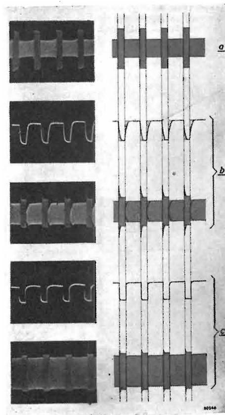
Fig. 3. - Influenza della costante di tempo di circuito di controreazione sul segnale intercarrier (vedi testo).
