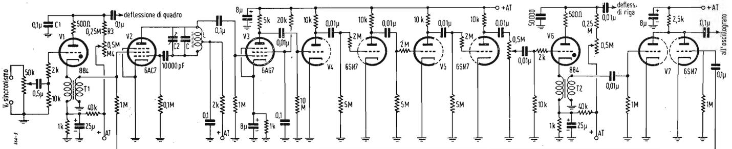
Fig. 1. - Circuito elettrico di principio. Il metodo che qui viene descritto invece di impiegare una catena di demoltiplicatori si avvale di una moltiplicazione di frequenza che viene fatta partendo dalla frequenza di quadro, opportunamente sincronizzata con la frequenza di rete.
