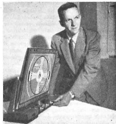
Fig. 1. - Il nuovo rivoluzionario televisore senza tubo catodico sviluppato nei laboratori della General Electric, presentato dall'inventore Lloyd T. De Vore direttore dei laboratori elettronici di Syracuse.
