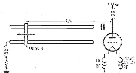
Fig. 13. - Oscillatore ultraudion a linea risonante.
