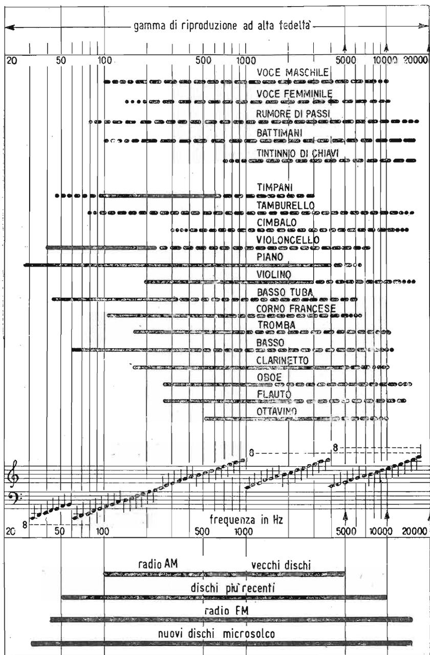
Fig. 4. - Diagramma di confronto degli spettri acustici dei vari strumenti e delle bande interessate da diversi tipi di riproduzione (radio AM ed FM, dischi 78 giri vecchi, dischi più recenti e microscolco).
