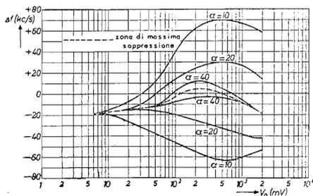
Fig. 4. - Fattore di soppressione  $\alpha$  del discriminatore a rapporto in funzione dei valori istantanei della deviazione di frequenza del segnale intercarrier e della tensione di uscita del discriminatore.
