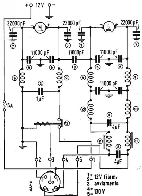
Fig. 2. - Schema elettrico dei dispositivi di filtraggio e silenziamento di un survoltore rotante di costruzione AEG (tipo EUa2).
