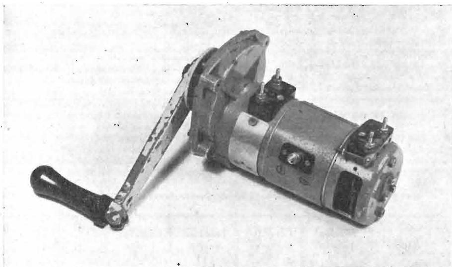
Fig. 4. - Generatore a manovella per l'alimentazione di una stazione portatile di soccorso
