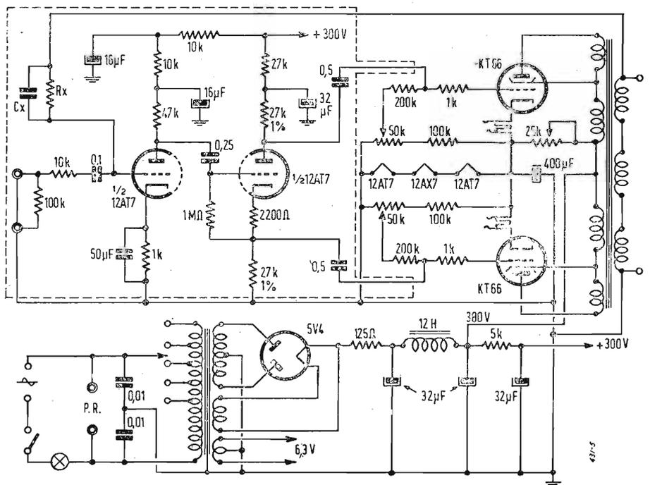
Fig. 3. - Schema elettrico dell'amplificatore finale. Da notare l'accensione in continua dei tubi, alimentati dalla corrente catodica dello stadio di potenza.
