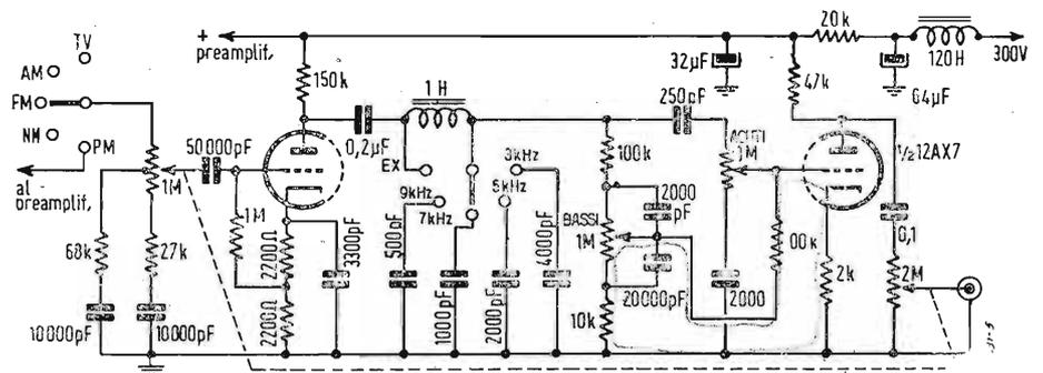
Fig. 2. - Schema elettrico del preamplificatore-equalizzatore con la regolazione fisiologica del volume, le regolazioni degli alti e dei bassi e il filtro (quattro posizioni, più la posizione di escluso).
